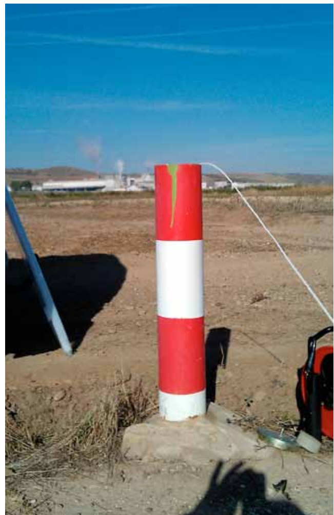
Piezómetro de control en el aluvial del Ebro en Lodosa.
