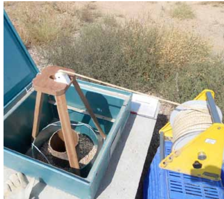
Red piezométrica. Prueba de prototipo de Trípode
