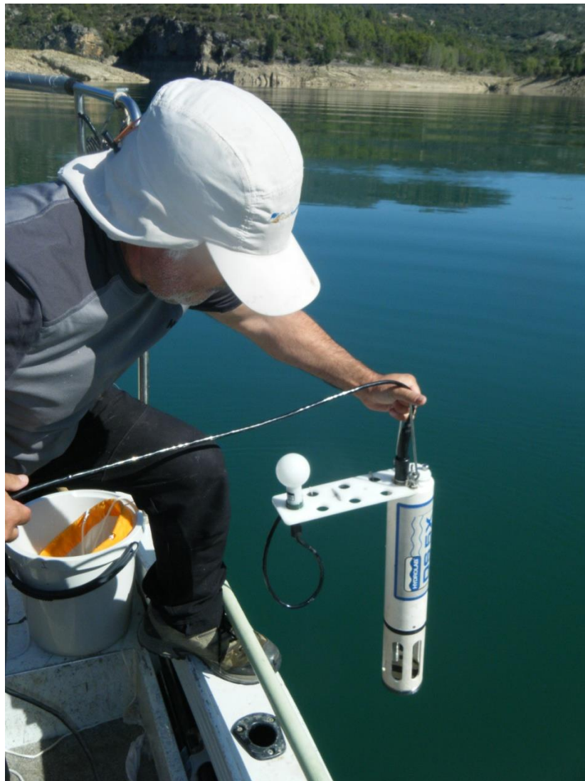
Figura 6. Perfil vertical mediante sonda multiparamétrica
